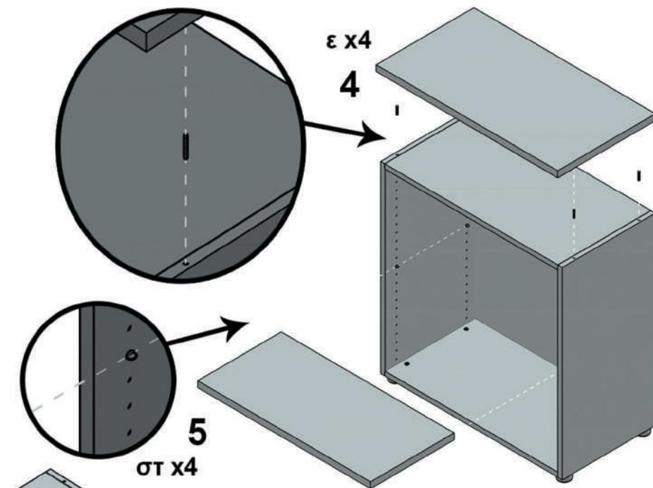
**1**-Συνδέουμε το ένα πλαινό με τη βάση και το καπάκι του ερμαρίου χρησιμοποιώντας 2 και 2 σετ εξαρτημάτων αντίστοιχα (α) / Assemble and secure one side piece with the base and the lid using 2 and 2 sets of tools respectively
