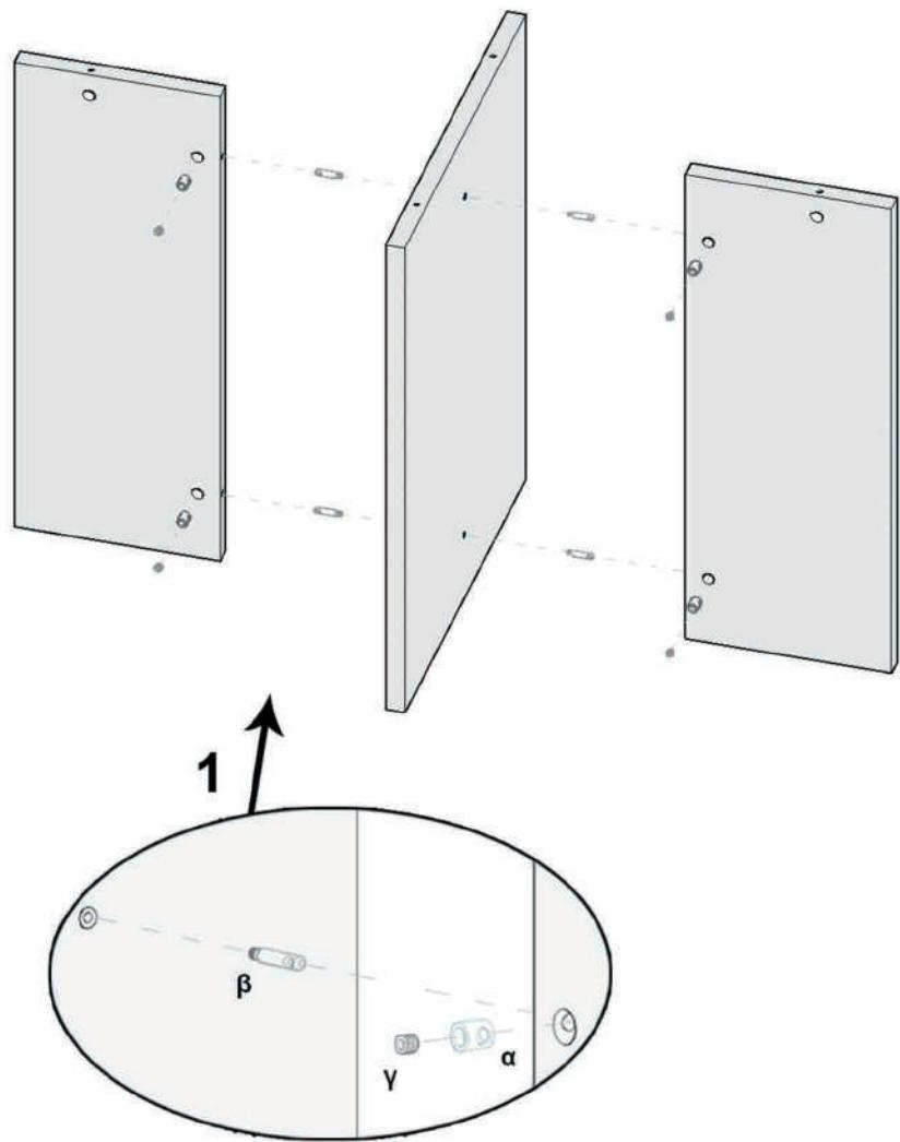
**1**-Συνδέουμε και ασφαλίζουμε τη οδαρικά του τραπεζιού, χρησιμοποιώντας 4 σετ εξαρτημάτων (Α,Β,Γ) / Assemble and secure the table legs using 4 toolsets
