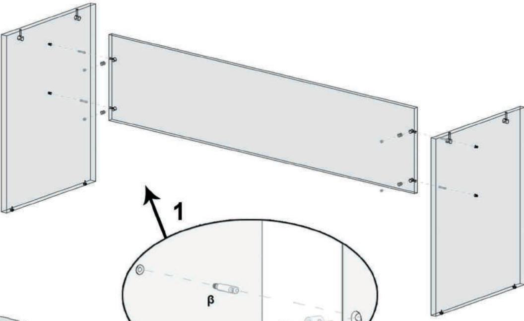
**1**-Συνδέουμε και ασφαλίζουμε τη μετώπη με τα ποδαρικά του τραπεζιού, χρησιμοποιώντας το σετ των μικρών εξαρτημάτων (α,β,γ) / Assemble and secure the base of the table using the small toolset
