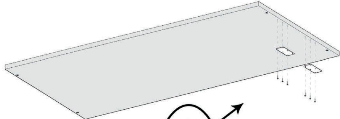
**1**-Βιδώνουμε τις λάμες στις τάβλες των 2 γραφείων ΠΡΙΝ συνδέσουμε με τα ποδαρικά, χρησιμοποιώντας 12 ξυλόβιδες (β) / Screw the blades to the desk surfaces BEFORE attaching them to the desk legs, using 12 of the wood-screws
