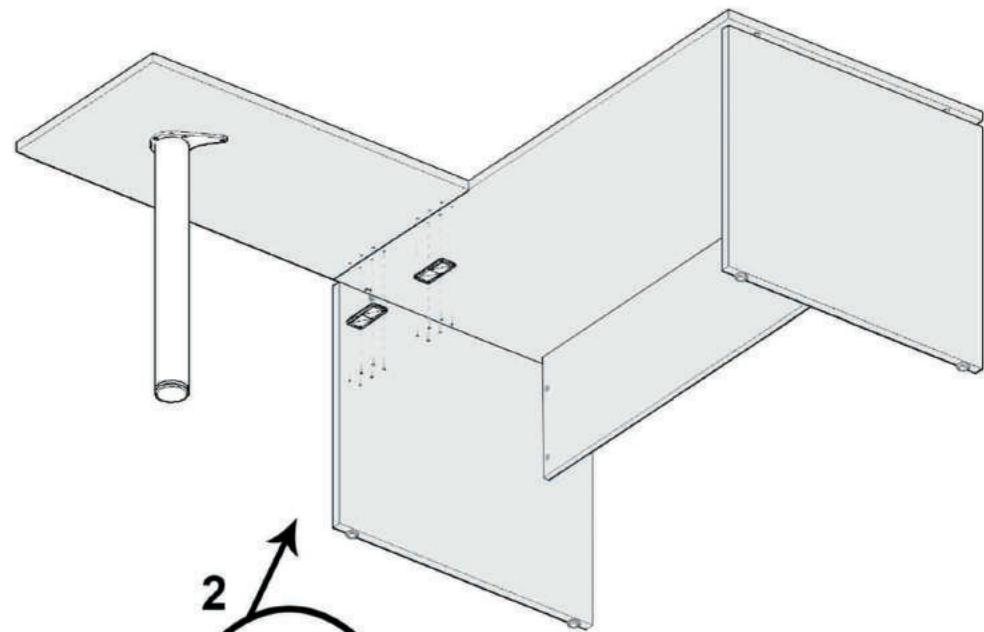
**1**-Βιδώνουμε το ποδαρικό στην τάβλα του βοηθητικού χρησιμοποιώντας 5 ξυλόβιδες (β) / Screw the leg to the surface using 5 of the woodscrews
